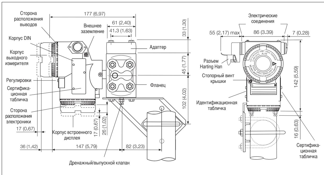
**Преобразователь с цилиндрическим корпусом из нержавеющей стали AISI на кронштейне (плоского типа для боксов) для вертикальной или горизонтальной установки на трубу диаметром 60 мм (2 дюйма)**
