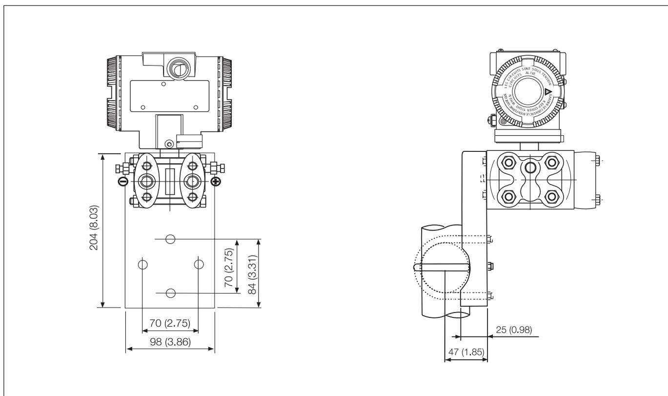
**Преобразователь на кронштейне для установки на стену (с помощью четырех винтов M8)**
