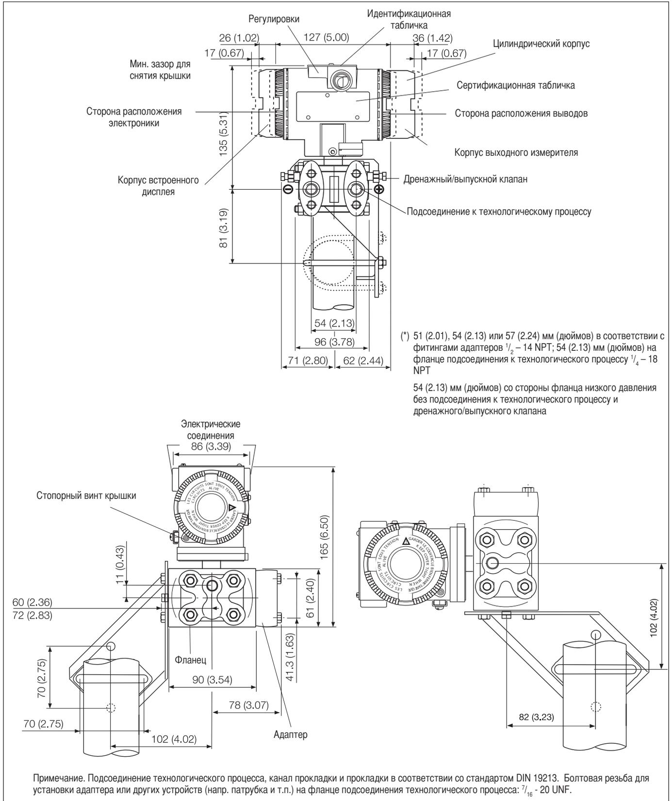
**Преобразователь на кронштейне для вертикальной или горизонтальной установки на трубу диаметром 60 мм (2 дюйма) (корпус DIN)**
