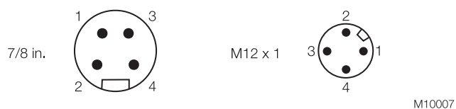
Рис. 7: Штекерный соединитель - версии для полевой шины
