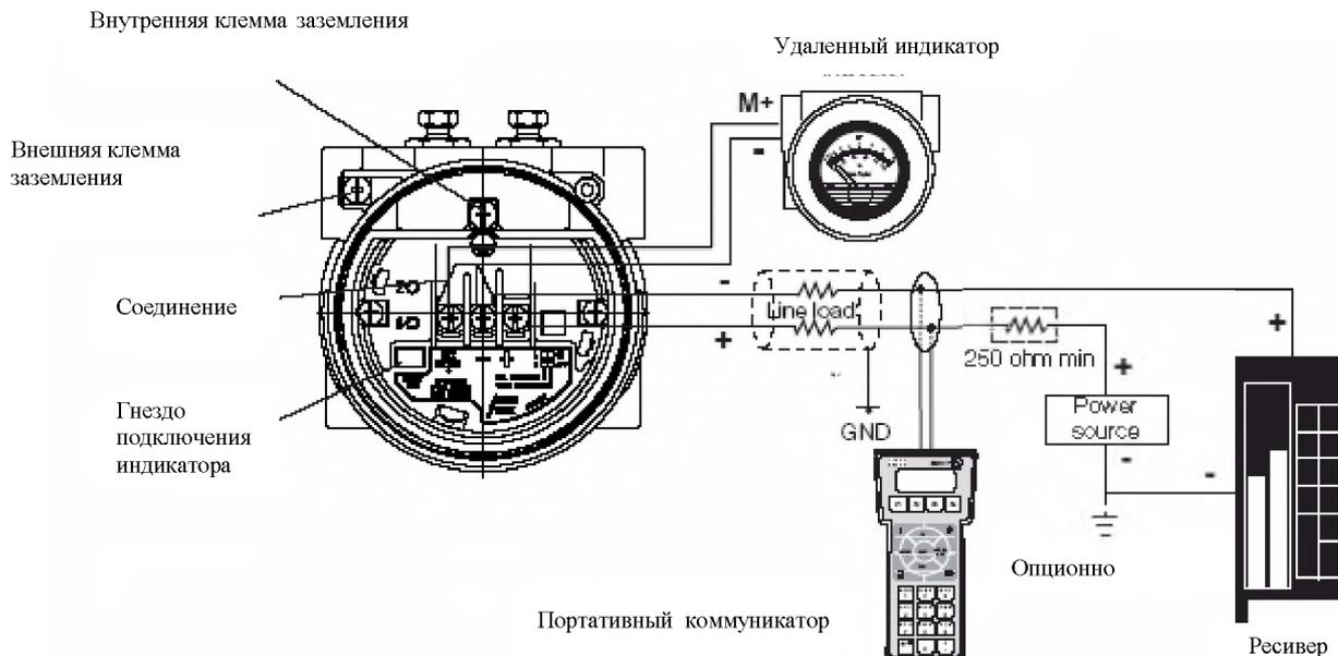
HART-коммуникатор может быть подсоединен в любой точке схемы при условии минимальным значения сопротивления 250Ом. При сопротивлении менее 250Ом, в систему необходимо добавить дополнительное сопротивление.
