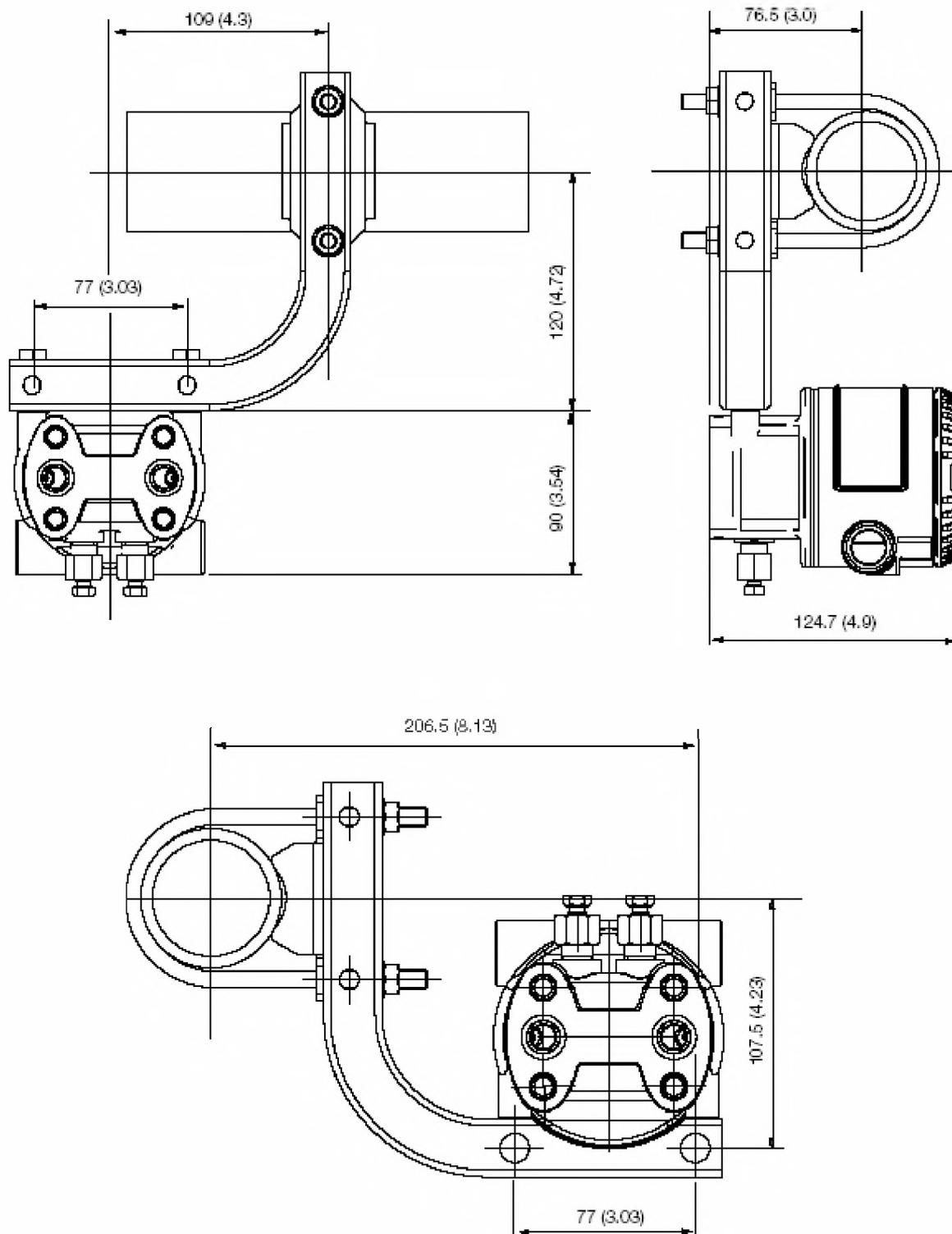
Преобразователь с кронштейном для крепления на стену
