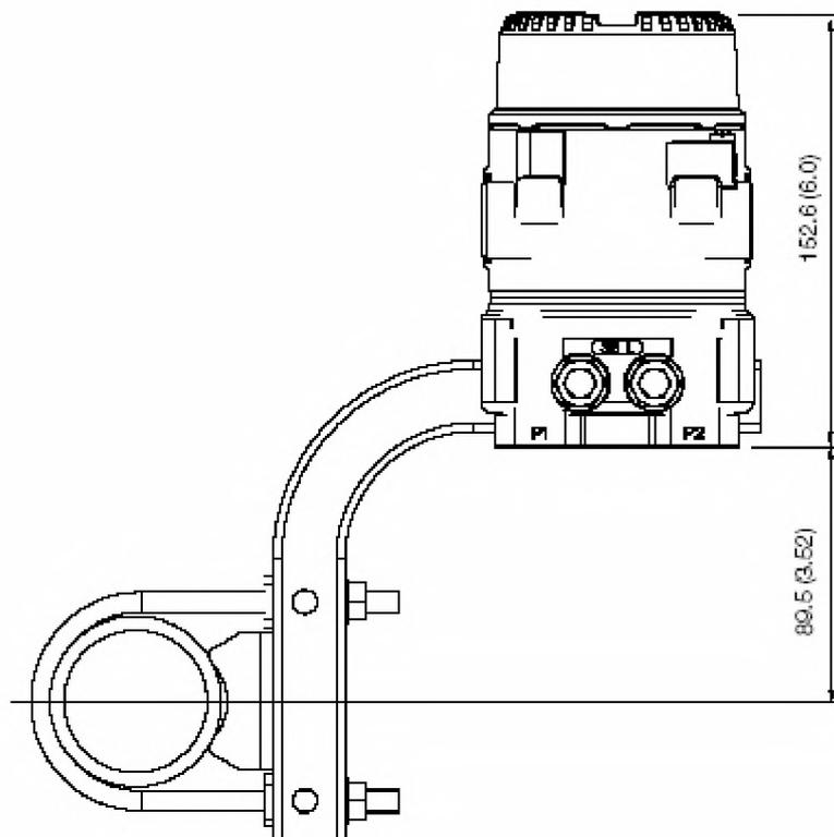
Преобразователь с кронштейном для горизонтального крепления на трубу
