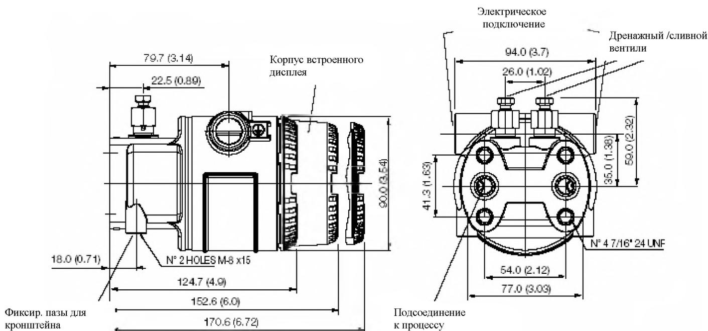
Преобразователь с кронштейном для вертикального крепления на трубу
