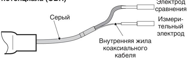
Рис. 2.7 Разделка кабеля – измерительные преобразователи серии 4600
