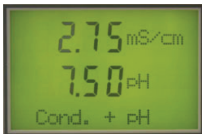
Одновременное измерение электропроводности и pH
