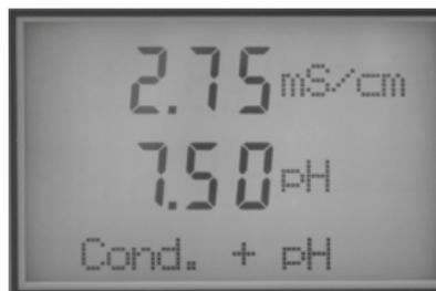
Одновременное измерение электропроводности и рН
