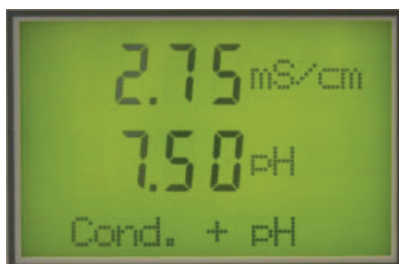
Одновременное измерение электропроводности и pH
