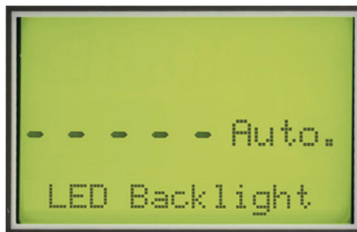
Можно задать автоматическое отключение задней подсветки при отсутствии активности
