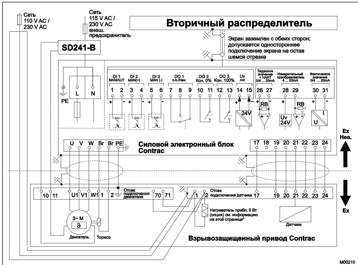
Рис. 3: электрическое подключение: взрывозащищенный привод аналоговый / двоичный
