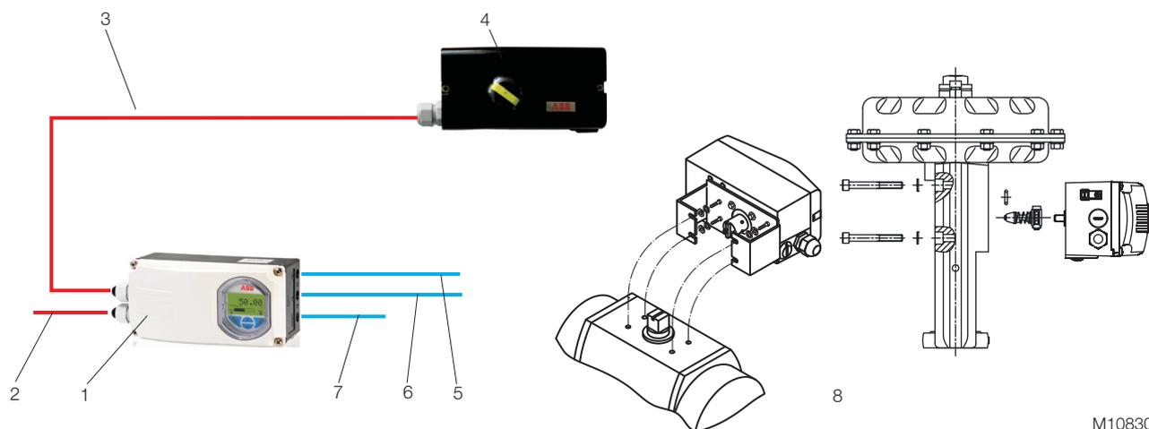
Рис. 25: Управляющий блок EDP300 с удаленным датчиком
