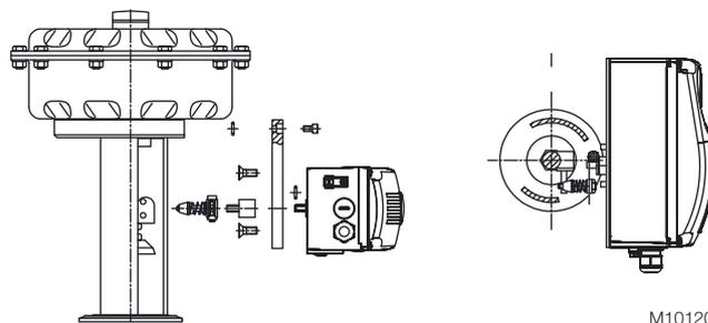
Рис. 5: Встроенный монтаж на регулирующие вентили с помощью платы адаптера
