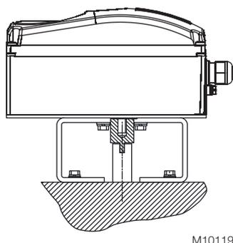
Рис. 3: Монтаж на поворотные приводы согласно VDI / VDE 3845
