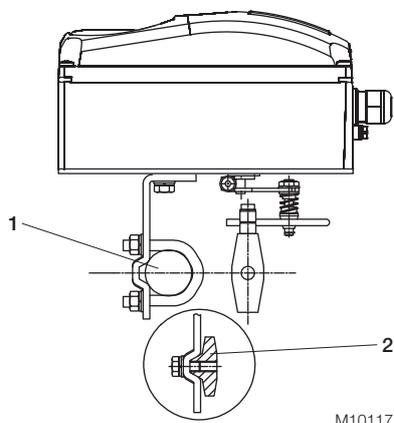
Рис. 2: Монтаж на линейные приводы согласно DIN/IEC 534
