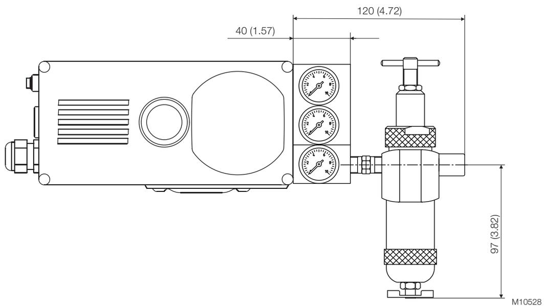
Рис. 15: Позиционный регулятор EDP300 со встроенным блоком манометров и фильтром-регулятором
