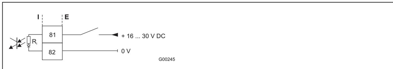
Рис. 47: переключающий вход для внешнего сброса счетчика и внешнего отключения выходов
