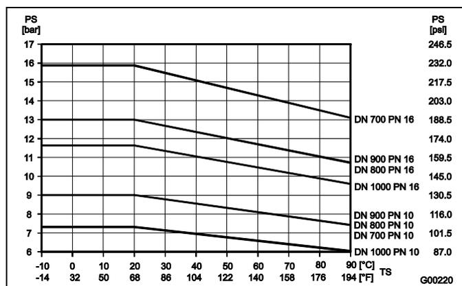
Рис. 21: Фланец DIN, сталь, DN 700 ... DN 1000 (28 ... 40")
