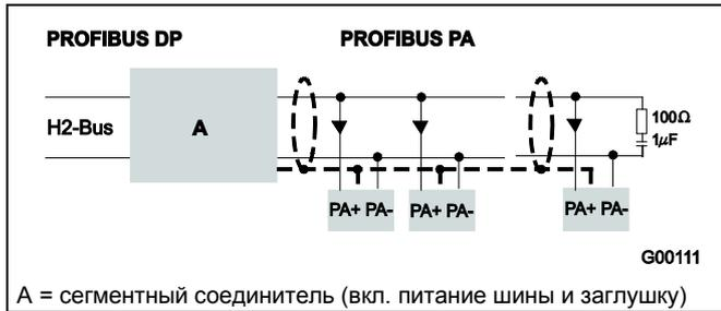
Рис. 39: пример подключения по интерфейсу PROFIBUS PA
