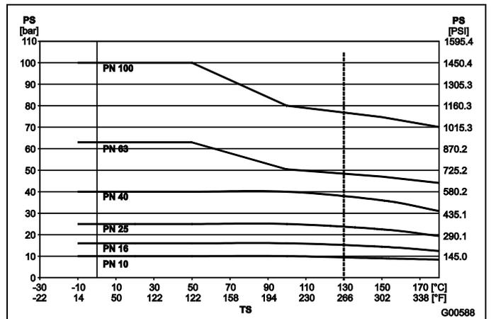
Рис. 18: Фланец DIN, сталь, до DN 600 (24")
