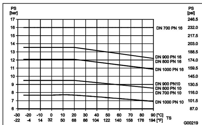
Рис. 20: Фланец DIN из нержавеющей стали, DN 700 ... DN 1000 (28 ... 40")
