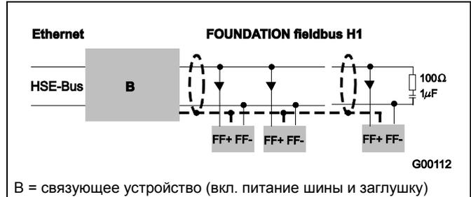
Рис. 40: пример подключения по интерфейсу FOUNDATION Fieldbus
