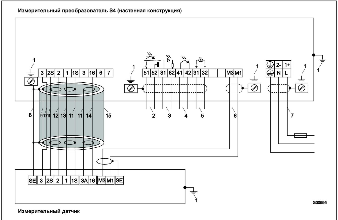
Рис. 41: Схема подключения стандартного измерительного датчика DN 10 ... DN 1000 (3/8 ... 40")
