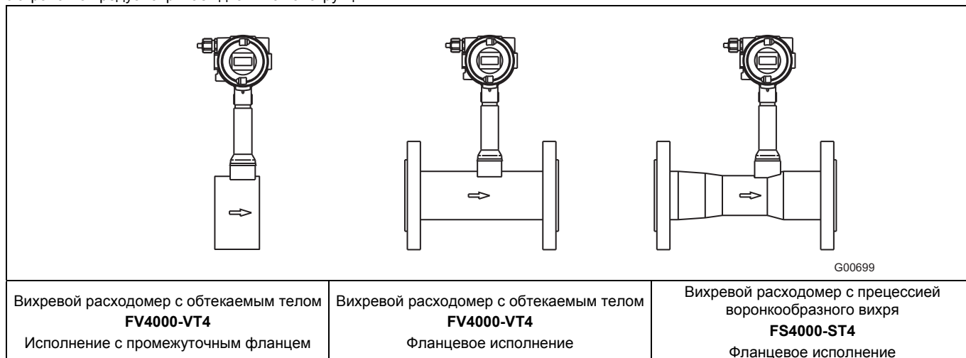
Рис. 4: Моноблочная конструкция: Преобразователь смонтирован непосредственно на датчике.
