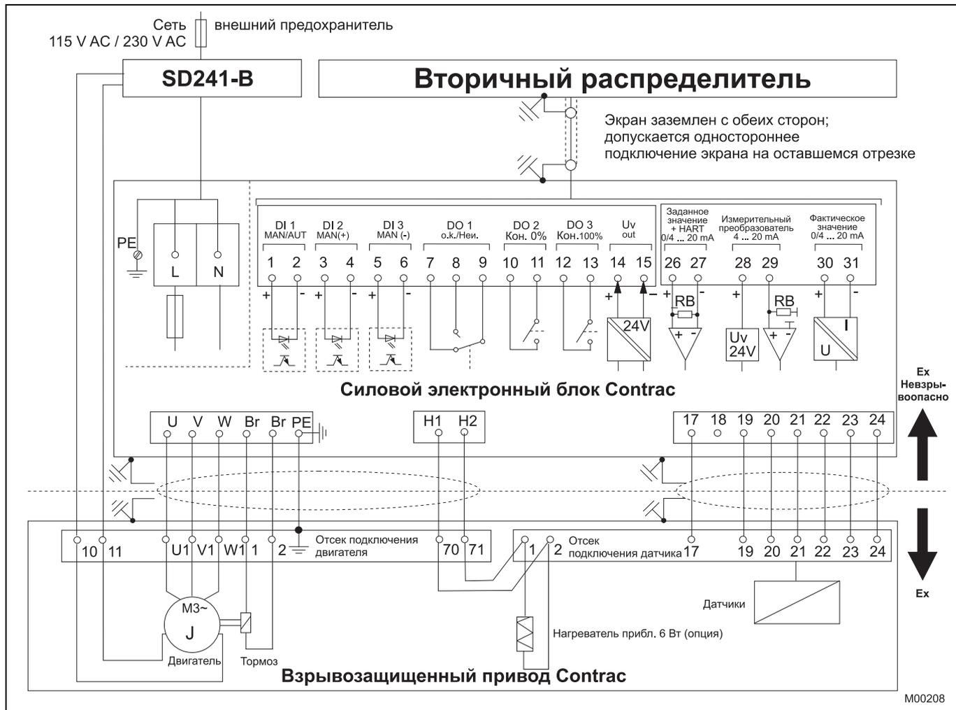
Рис. 2: электрическое подключение: взрывозащищенный привод аналоговый / двоичный
