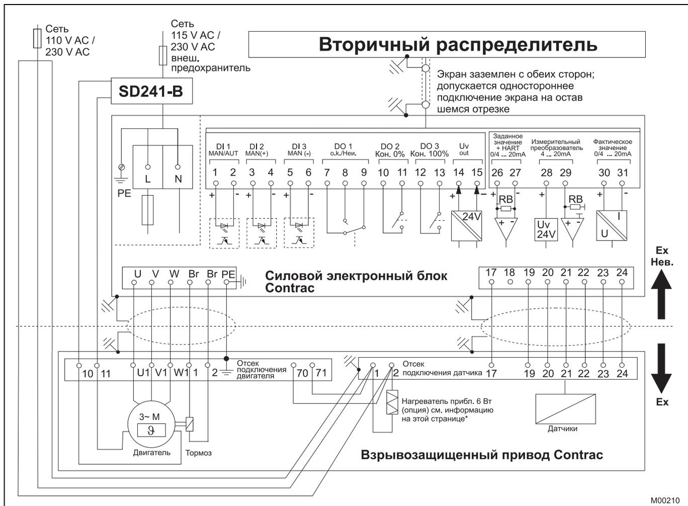
Рис. 6: электрическое подключение: взрывозащищенный привод аналоговый / двоичный
