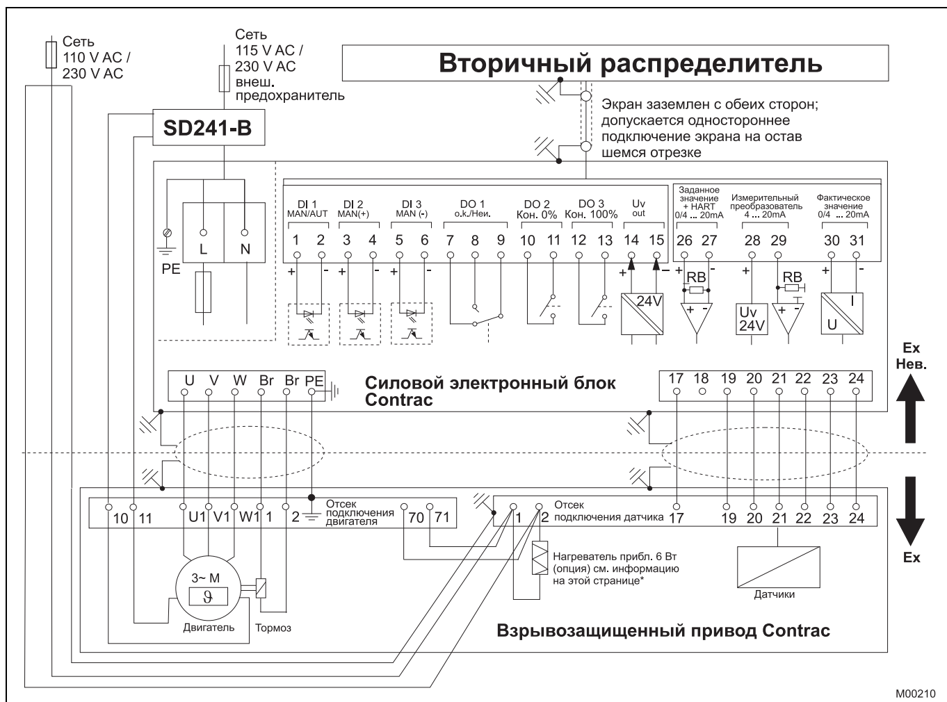
Рис. 6: электрическое подключение: взрывозащищенный привод аналоговый / двоичный
