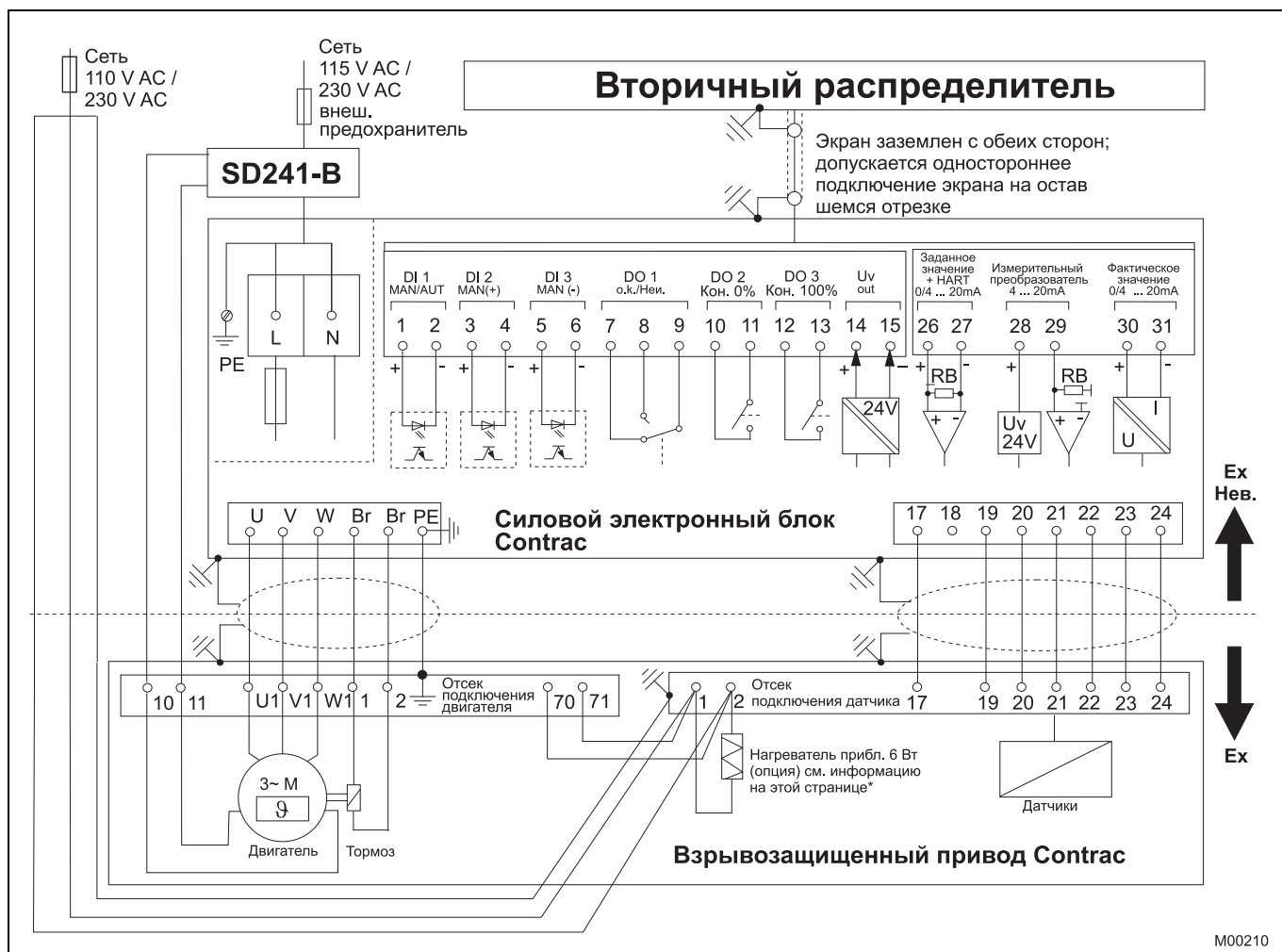
Рис. 4: электрическое подключение: взрывозащищенный привод аналоговый / двоичный
