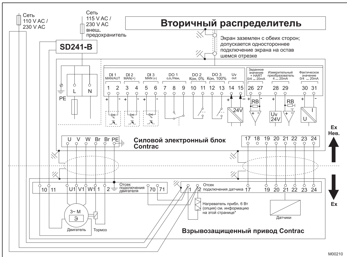
Рис. 4: электрическое подключение: взрывозащищенный привод аналоговый / двоичный
