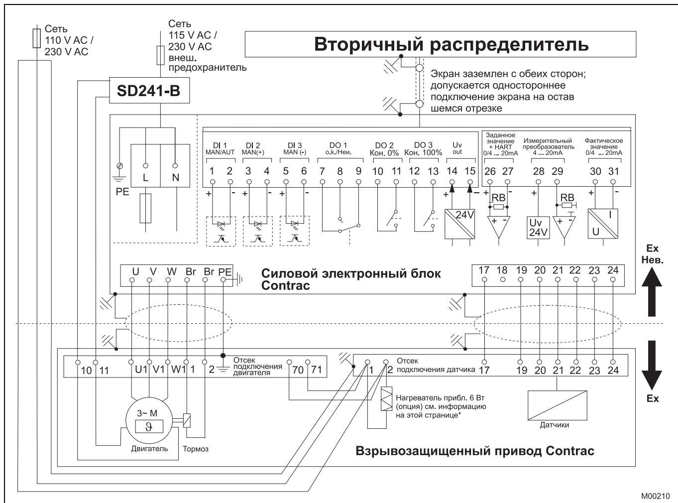
Рис. 4: электрическое подключение: взрывозащищенный привод аналоговый / двоичный
