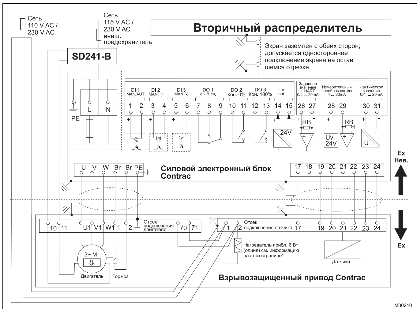
Рис. 4: электрическое подключение: взрывозащищенный привод аналоговый / двоичный
