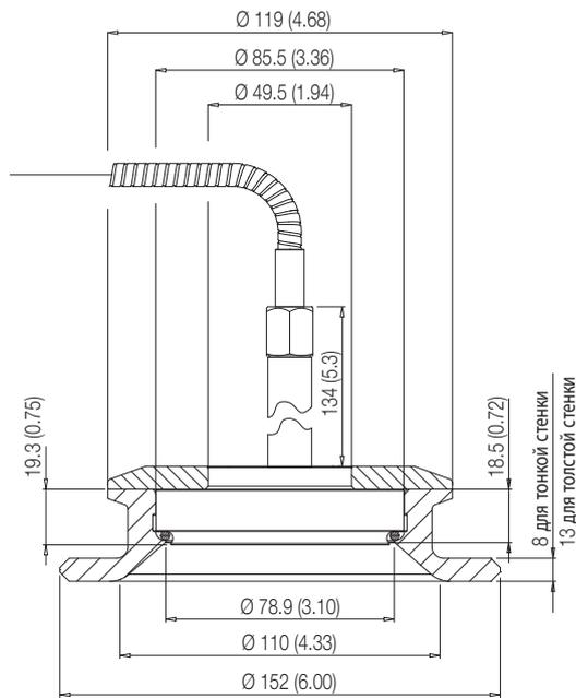
Гигиеническая удаленная разделительная мембрана предназначена для соединения с 4" патрубком гигиенического резервуара. Патрубок резервуара и уплотнение для технологического процесса поставляются с разделительной мембраной.
