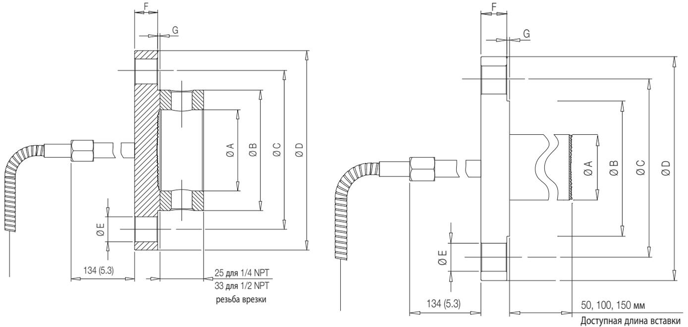
ASME и EN 1092-1 гладкая и Форма В1 (промыв. кольцо в качестве опции, только для плоского исполнения)
