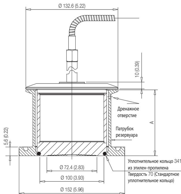
ПРИМЕЧАНИЕ: Патрубок резервуара, необходимый для подключения данной разделительной мембраны, должен быть приварен к технологическому аппарату до подключения разделительной мембраны в соответствии с рекомендуемой процедурой сварки и проведения испытаний под давлением.
