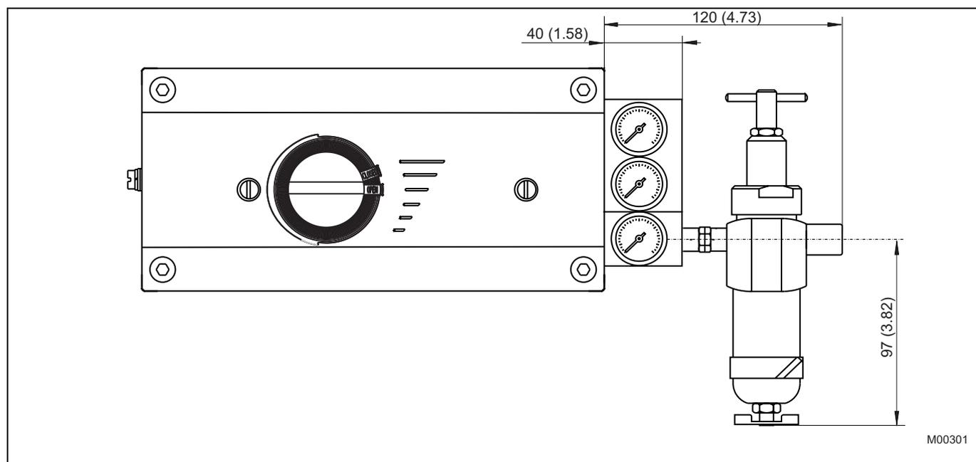
Рис. 12: Позиционный регулятор TZIDC-220 с установленным блоком манометров и фильтром-регулятором
