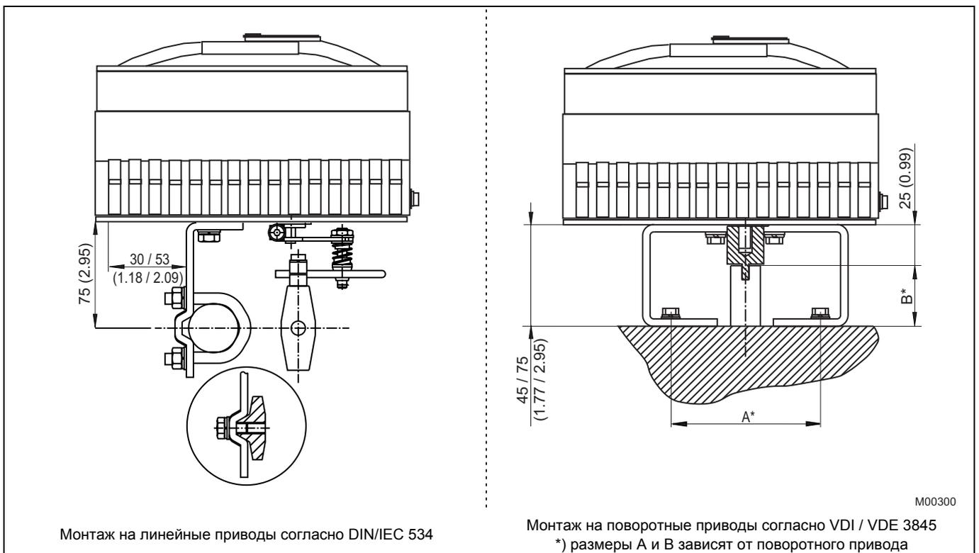
Монтаж на линейные приводы согласно DIN/IEC 534
