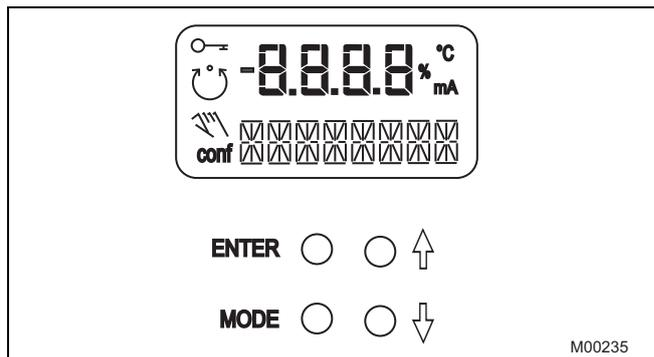
Рис. 4: Органы управления и индикации регулятора TZIDC-220
